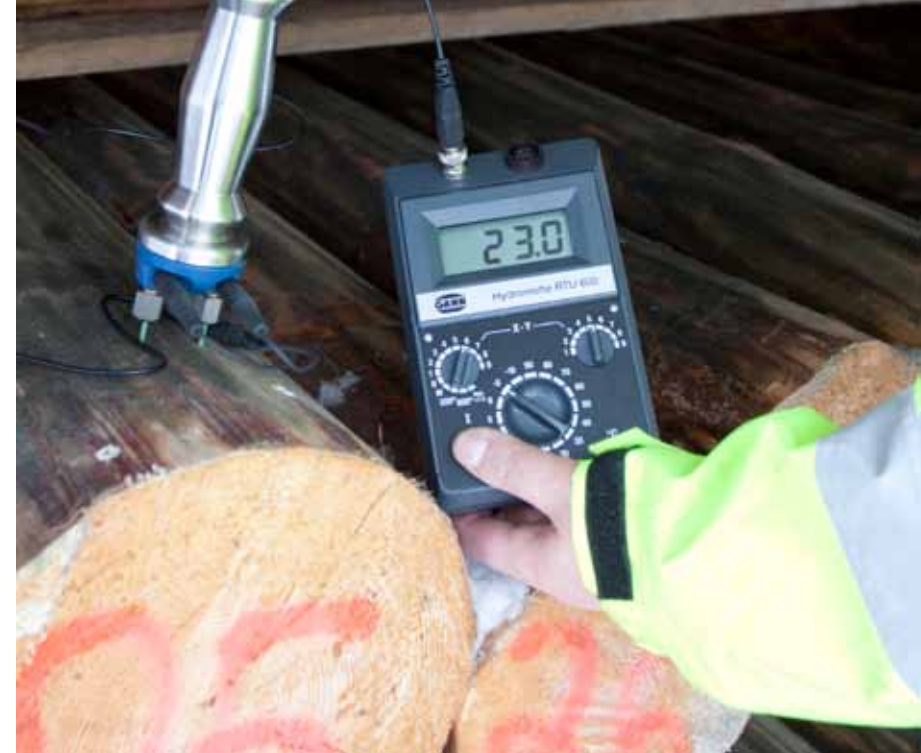
Kymmenen kuukautta taapelissa kuivamassa olleita hirsiiä. Vielä muutama kuukausi ja nämä ovat veistokunnossa.
